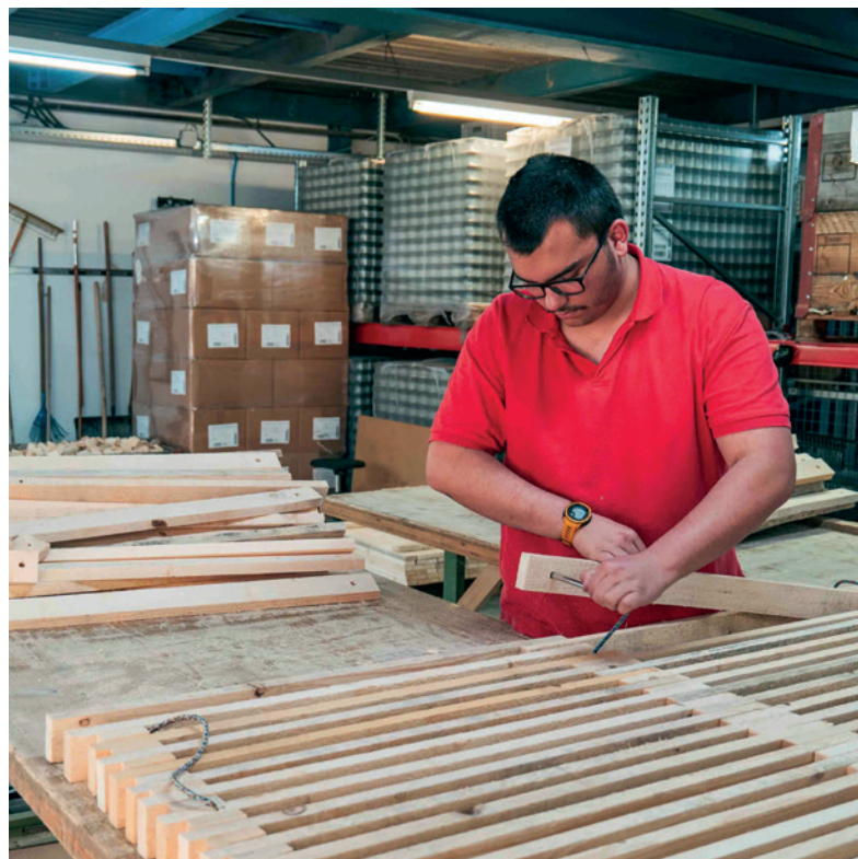
Fabrication de caillebotis en bois - Monthey - @fondationsainthubert
